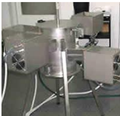
Ryc. nr 1. Reaktor ATON 2 przeznaczony do utylizacji niewielkich ilości odpadów szczególnie niebezpiecznych
